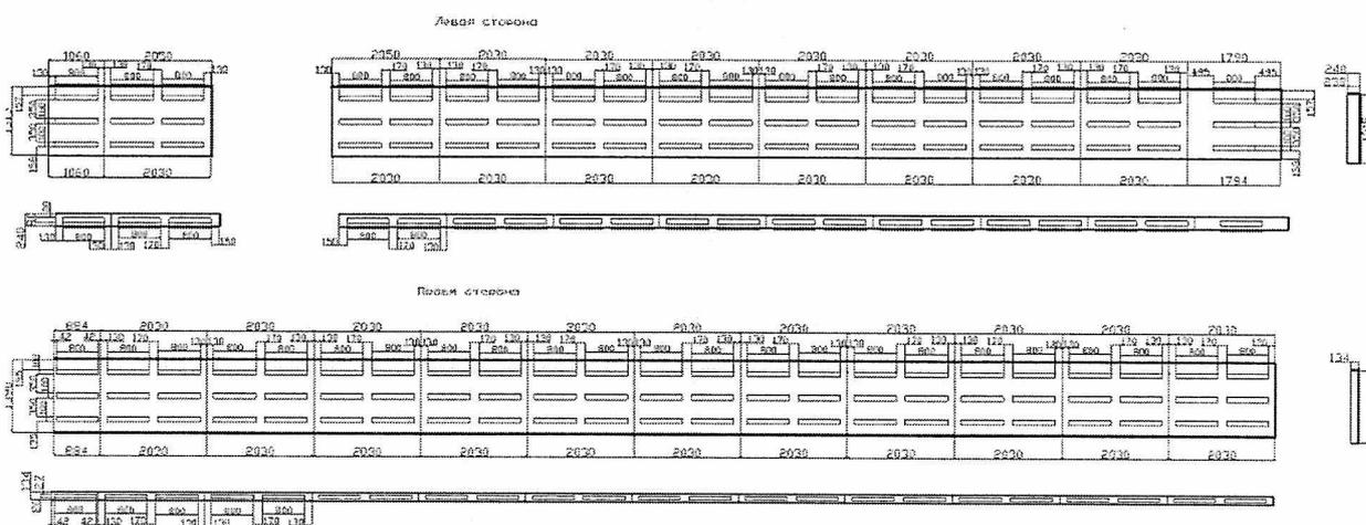
Материал панелей: ЛДСП 16 мм, облицованное кромкой ПВХ 0,5мм, верхние щиты облицованы кромкой ПВХ 2,0 мм.
