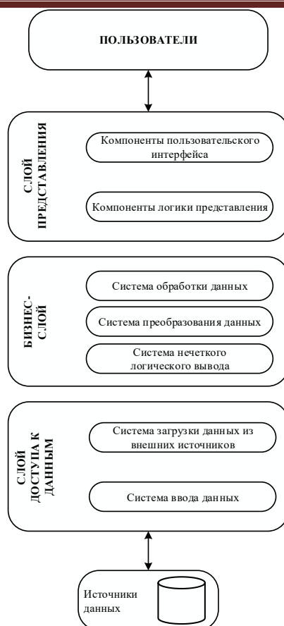
Рис. 2. Архитектура разрабатываемого приложения
